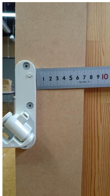
取付け位置：後から 70.5mm ねじの緩み、ガタツキ等なし
